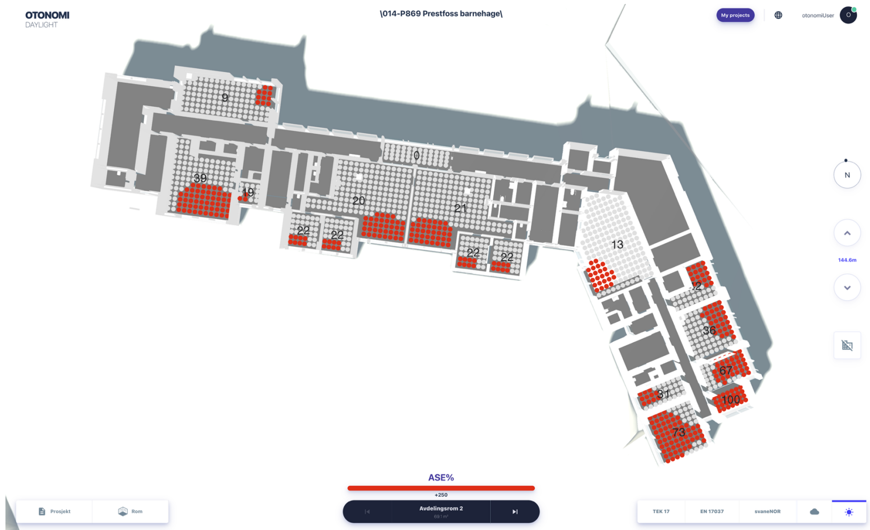
Figur 18: Punktverdier og gjennomsnittlige ASE verdier. Verdier over 25% indikerer risikoen for høy solinnstråling om sommeren, som ofte må kompenseres med skyggelegging eller overdimensjonert klimaanlegg.
