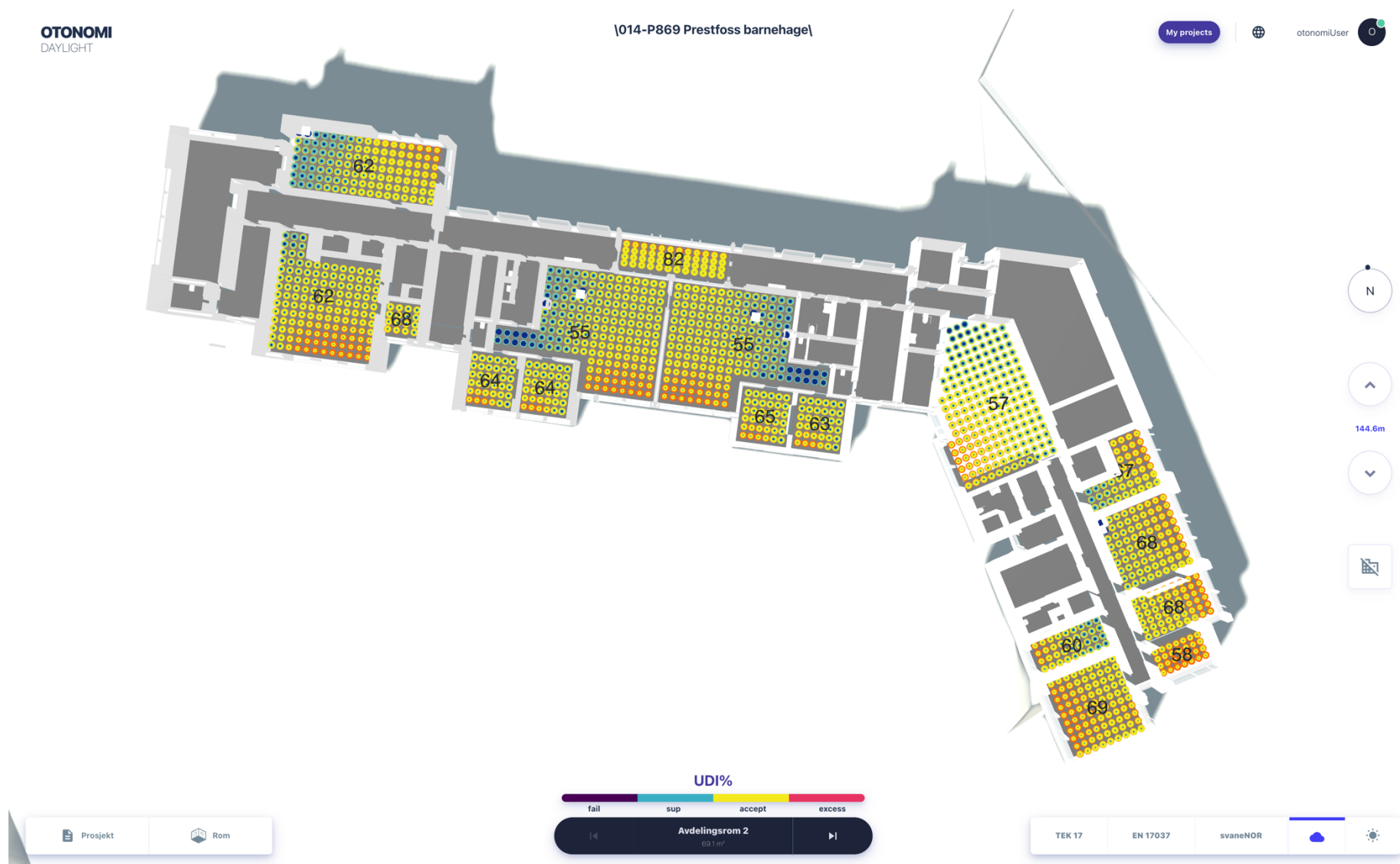
Figur 17: Punktverdier og gjennomsnittlige UDI verdier. Røde sirkler viser svært høye luxverdier som kan forårsake blinding, redusere visuell komfort og behovet for solskjerming.
