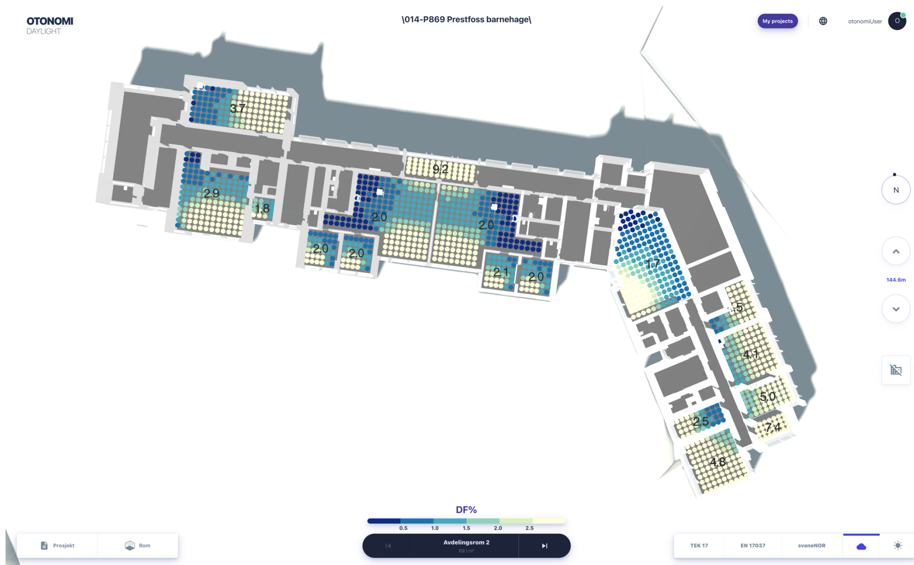
Figur 16: Punktverdier og gjennomsnittlige dagslys faktorer. Selv på overskygget dager er det godt med dagslys i rommene.
